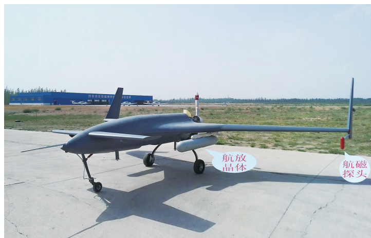
图5-6 彩虹-3无人机航空物探（磁/放）综合站
